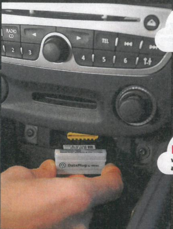
STECKPLATZ Die OBD-2-Schnittstelle ist meist unterhalb des Armaturenbretts in der Nähe des Fahrersitzes zu finden
