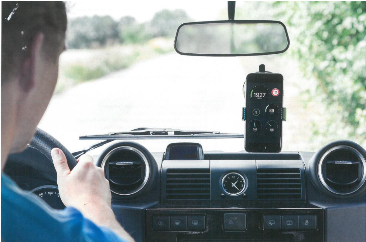
Schnittstelle zu den Fahrzeugdaten. Der Pace-Dongle greift die Daten am OBD-Steckplatz ab und gibt sie an die App weiter
